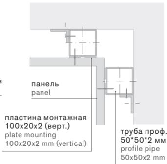
**Узел крепления стыка двух панелей внутренний угол под 90°.**
