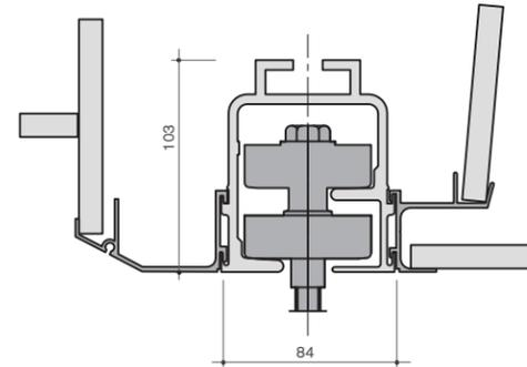
Максимальная масса секции, подвешиваемой на двухроликовом треке, не более 450 кг.
