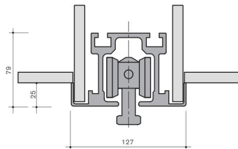
Предельно допустимая нагрузка на ролик не более 400 кг.
