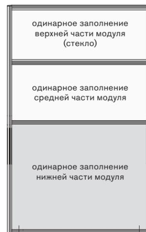
Модуль комбинированный с 2-мя поперечинами «NAYADA-UNO»
