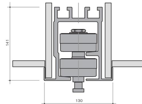
Предельно допустимая нагрузка на пару роликов не более 650 кг.
