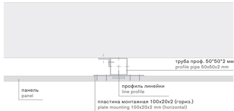
**Узел крепления стыка двух панелей через линейку, стык 10 мм.**
