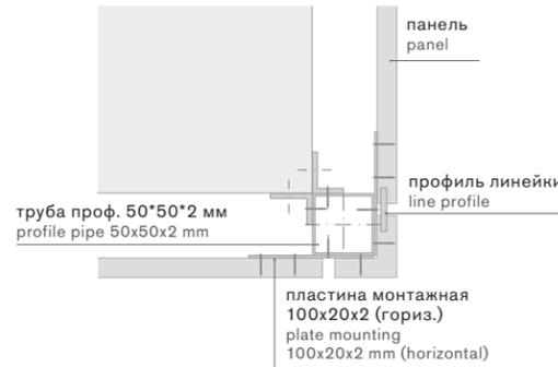
**Узел крепления стыка двух панелей внешний угол под 90° через линейку, стык 10 мм.**
