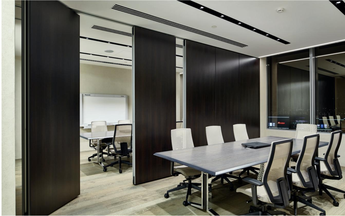
Система трансформируемых перегородок премиум-сегмента. Снабжена специальным лепестковым уплотнителем и магнитной лентой, которые обеспечивают плотное смыкание секций и повышенный уровень звукоизоляции. В данной системе возможно применение одностворчатых и двухстворчатых дверей.
