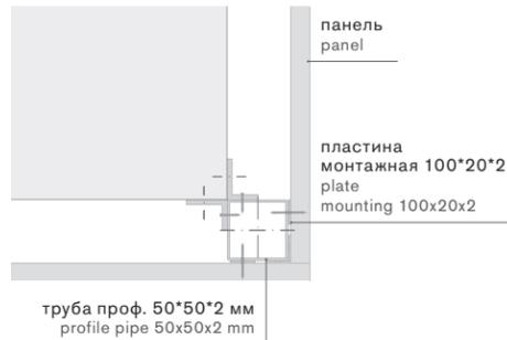
**Узел крепления стыка двух панелей внешний угол 90°.**
