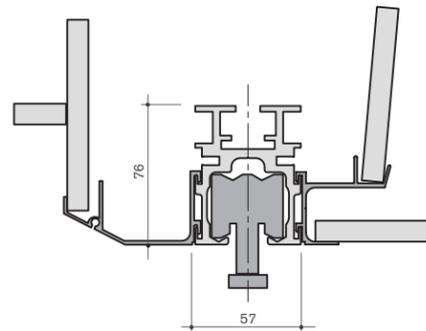
Предельно допустимая нагрузка на ролик не более 180 кг.
