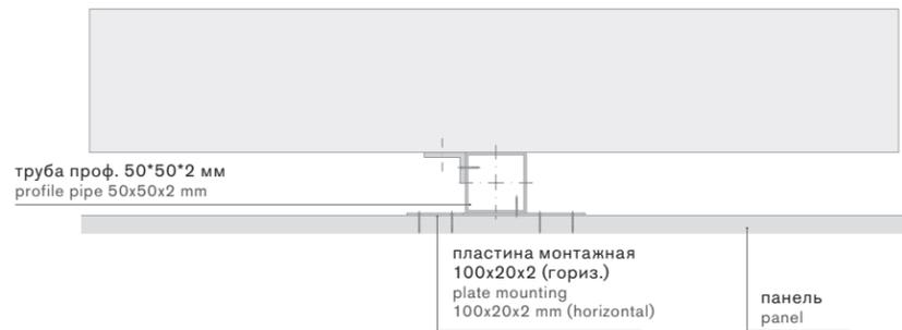
**Узел крепления стыка двух панелей.**
